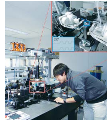
光導波路の測定
