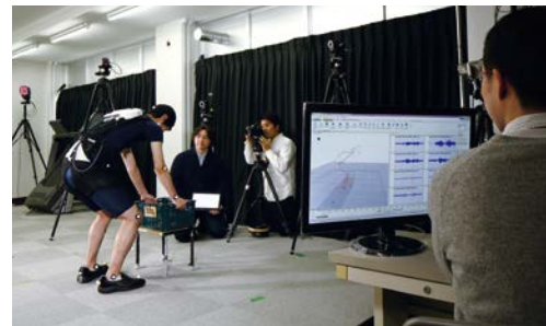
パワーアシストスーツ設計・評価のための動作計測実験
