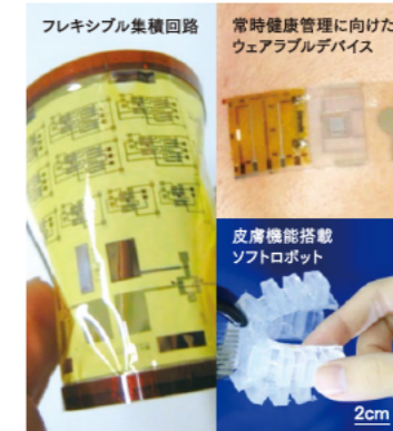
無機ナノ材料と機械学習を融合したフレキシブルセンサシステム
