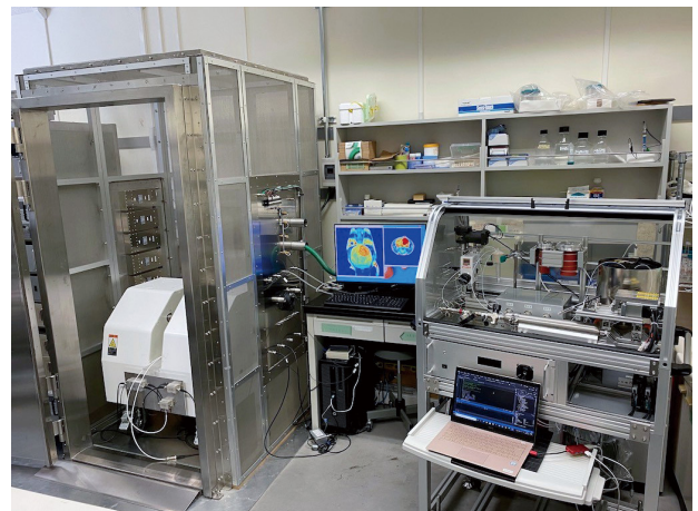
北大で学生と自作した1.5T多核MRI装置 (左) と パラ水素誘起超偏極型の ^{13}\text{C} 超偏極装置 (右)
